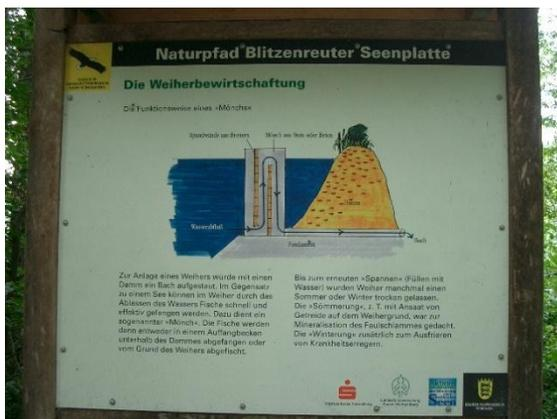
Inhalt: Um ein Weiher anzulegen, wird mit einem Damm ein Bach aufgestaut. Fische im Weiher kann man schnell und effektiv fangen, indem man das Wasser ablässt. Dies geschieht durch einen sogenannten „Mönch“. Die Fische werden dann entweder in einem Auffangbecken unterhalb des Dammes abgefangen oder vom Grund des
